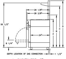
A — ISLAND TRIM HEIGHT — 35" B — 6" STANDARD BACKGUARD HEIGHT — 40 1/2" C — 17" BACKGUARD HEIGHT — 51 1/2" D — HIGH SHELF BACKGUARD HEIGHT — 58 1/4"
