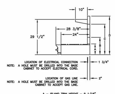
A - ISLAND TRIM HEIGHT - 9 1/16" B - 6" STANDARD BACKGUARD HEIGHT - 14-9/16" C - 17" BACKGUARD HEIGHT - 25-9/16" D - HIGH SHELF BACKGUARD HEIGHT - 32 5/16"
